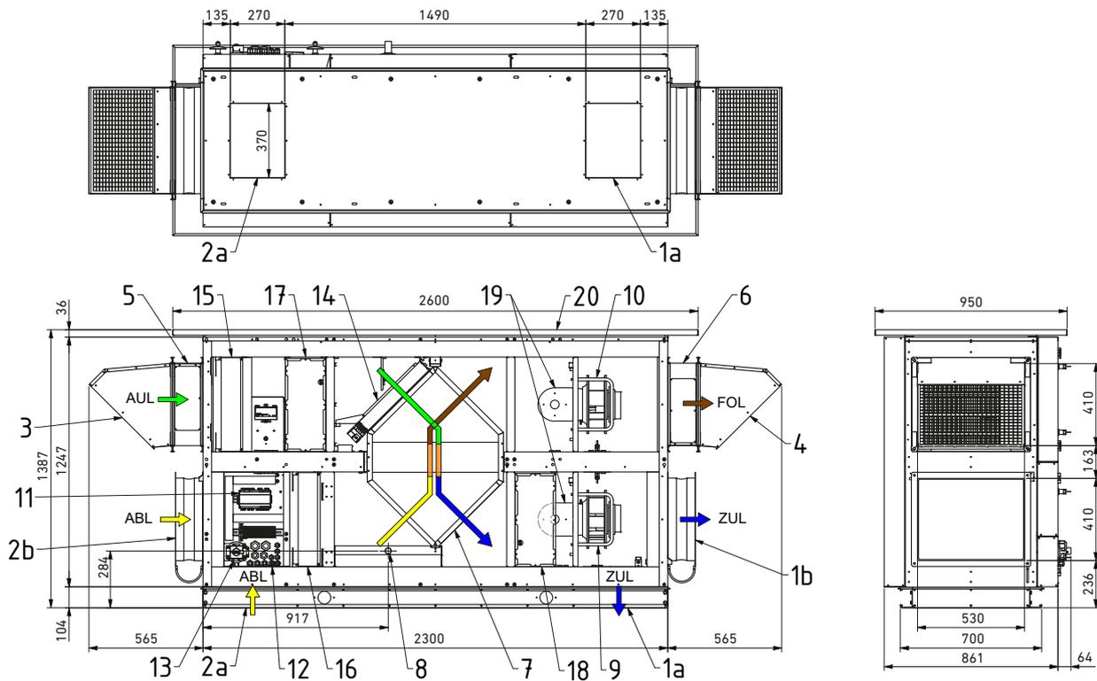
1a Zuluftanschluss dachintegrierte Ausführung für Schiebepanzen
