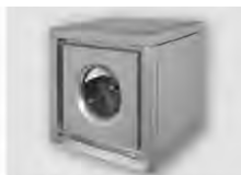
MPC...DT (bis 15.750 m 3 /h) Kubische Abluftbox für Küchenabluft, frequenzsteuerbar, bis max. 120 °C, Anschluss Ø 225 – 630 mm
