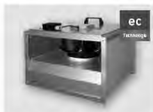
KVRI...EC (bis 11.505 m 3 /h) Rückwärtsgekrümmtes Radiallaufrad, schallisoliert, EC-Motor, Anschluss 500 x 250 – 1.000 x 500 mm
