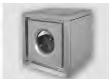
MPC...ET (bis 7.800 m 3 /h) Kubische Abluftbox für Küchenabluft, Fördermitteltemperatur bis max. 80 °C zulässig, Anschluss Ø 225 – 500 mm
